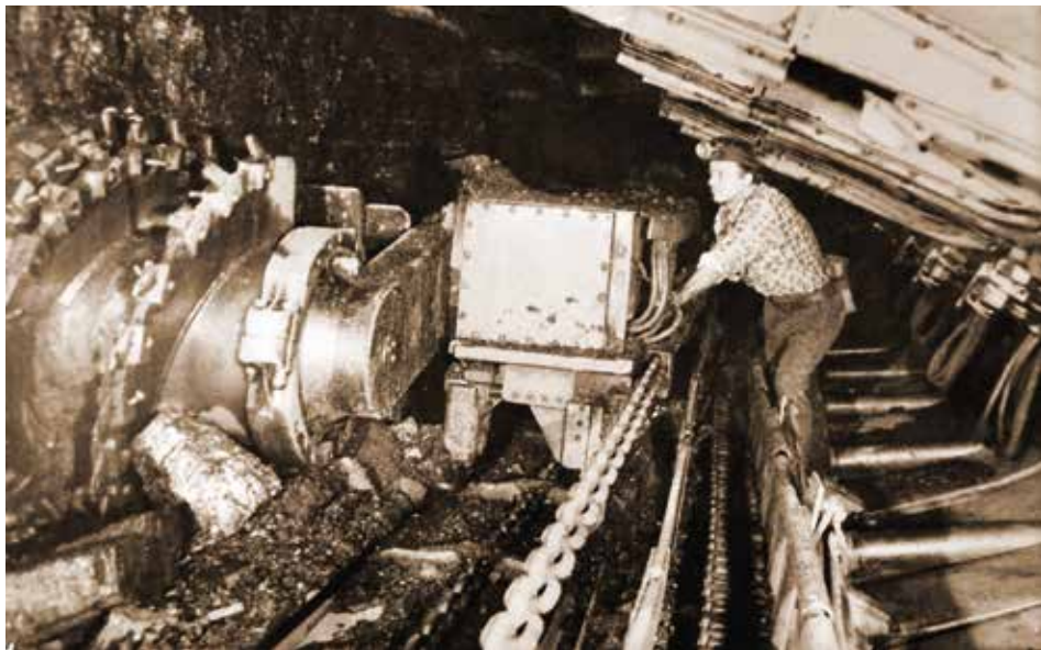
Kombajnowa ściana zmechanizowana w latach 80. XX wieku.
